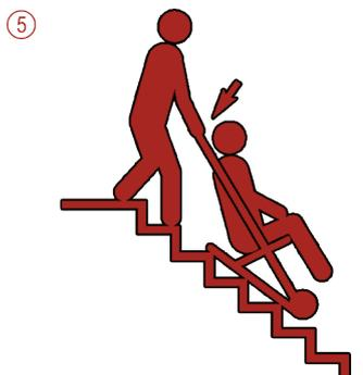
4. Befestigen Sie den Sicherheitsgurt. Fahren Sie zügig direkt zum Treppenhaus (Fluchtweg) oder zu einer Nottreppe. Kurz vor der ersten Stufe stellen Sie den Rettungsstuhl wieder in den Balancepunkt und drücken mit dem Fuß den Kickständer nach innen.
