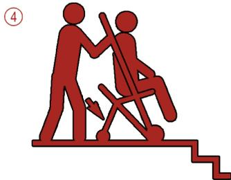
3. Die Person, die evakuiert werden soll, kann sich in den Stuhl setzen. Ziehen Sie ihn dann bis zum Balancepunkt auf sich zu und nehmen erst dann den Fuß vom unteren Bügel. Stellen Sie den Fuß auf das untere Rohr des Kickständers und ziehen ihn nach hinten zurück. Die Gasfeder unterstützt diesen Vorgang. Der Rettungsstuhl ist jetzt vollständig aufgeklappt und für den horizontalen Transport fahrbereit.
