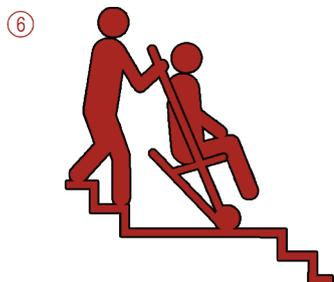
5. Setzen Sie den Ph-RESCUE-CHAIR® auf die Treppe. Wenn die Gleitriemen die erste Stufe berühren, tritt die Bremswirkung ein. Sobald die zweite Stufe erreicht ist, nehmen Sie die Hände an den Griffbügel und gleiten unter dem gleichen Winkel die Treppe weiter abwärts.
